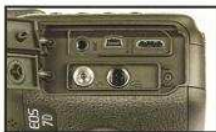
▲ Connectiques complètes avec entrée micro et sortie HDMI. La vidéo analogique passe par l'USB.
